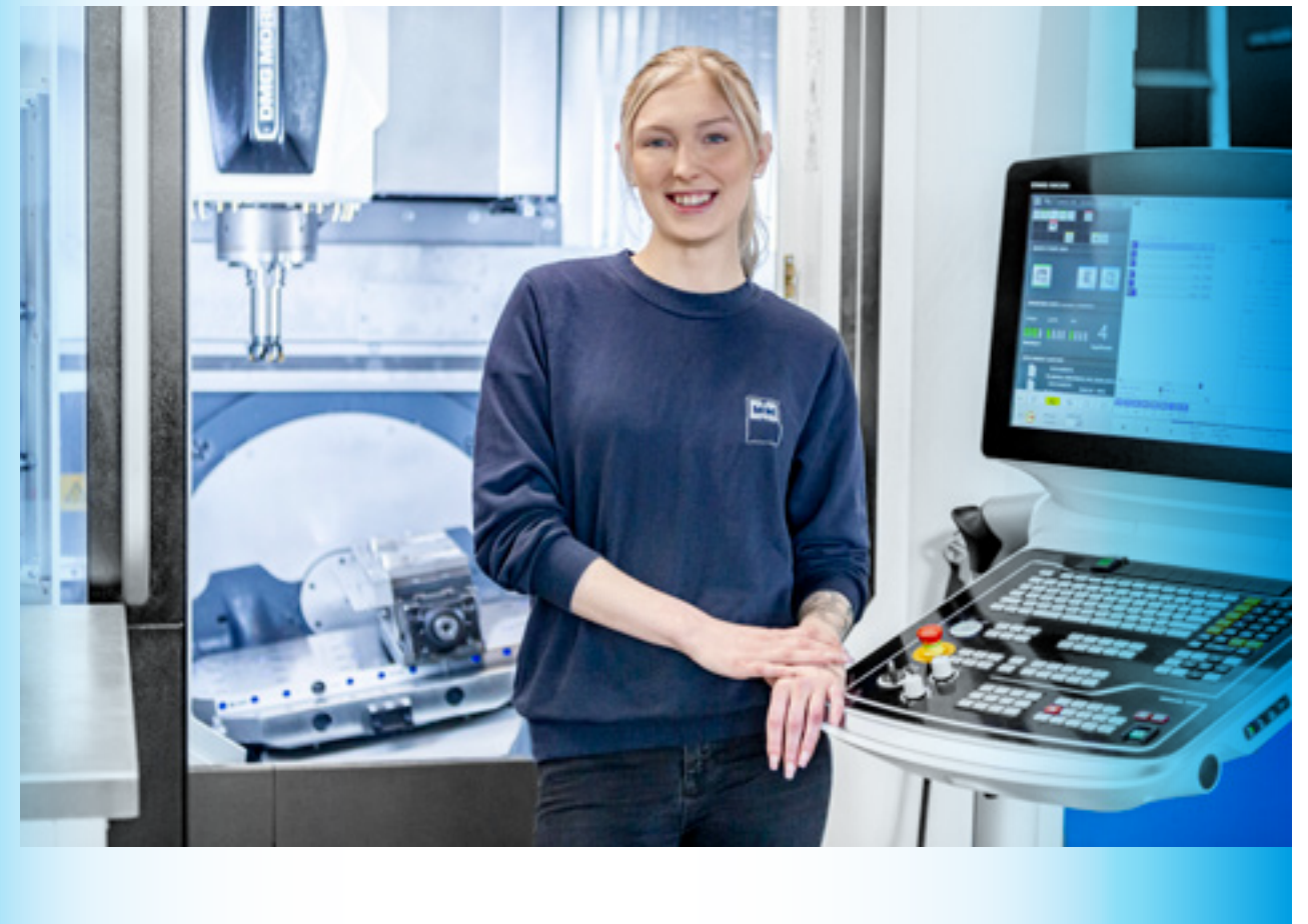
Julia Hilburger an der DMU 50 – mit dieser modernen Maschine können fünf Achsen bearbeitet werden. Damit wird das Umspannen von Werkstücken reduziert und die Bauteile können in höherer Qualität und innerhalb kürzerer Zeit hergestellt werden als bisher.
